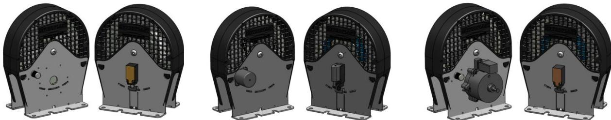
1. Установить ограничитель скорости над окнами так, что бы точка сбега каната с большого шкива и точка закрепления каната к рычагу механизма включения ловителей на кабине, находилась на одной вертикальной линии с отклонением не более 5 мм. Так же при установке ограничителя скорости необходимо, чтобы угол между осью шкива и вертикалью был не более 3°.
