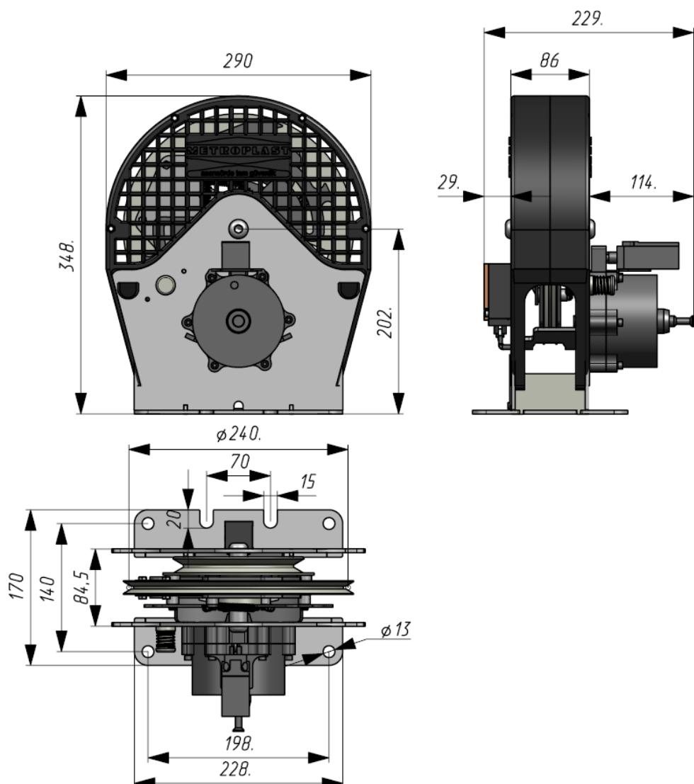
Ограничитель скорости рассчитан на работу с **канатом диаметром 6 мм.**
