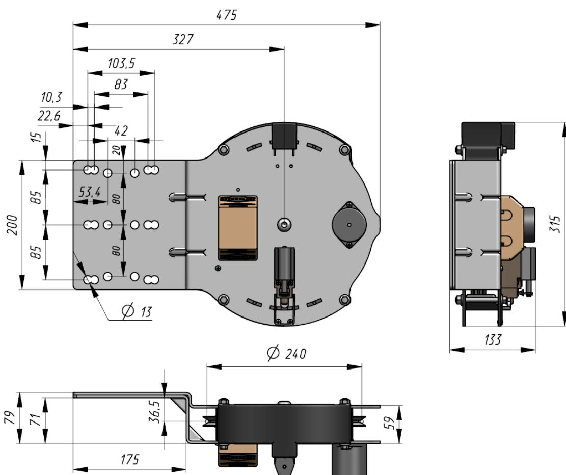
Ограничитель скорости рассчитан на работу с **канатом диаметром 6 мм**.
