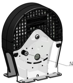
Нажать на кнопку блокировки **поз.14**, ограничитель скорости при этом должен сработать.
