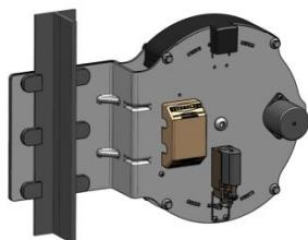
1. Закрепить ограничитель скорости на направляющую при помощи 6 прижимов (не входят в комплект поставки) так, что бы точка сбега каната с большого шкива и точка закрепления каната к рычагу механизма включения ловителей на кабине, находилась на одной вертикальной линии с
