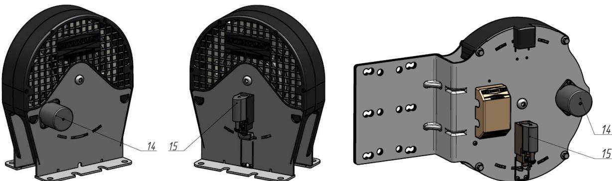
Отличие моделей 115 OC Moment 250 MRL, 119 OC Moment 250 MRL/1 от 113 OC Moment 250 MR в том, что вместо ручного механизма блокировки **поз.14** в данном варианте используется электромагнит, который выдвигает шток и управляется дистанционно. Также на выключатель **поз.13** закреплен еще один электромагнит **поз.15**, который воздействует на ролик выключателя **поз.13**, возвращая его в исходное положение.
