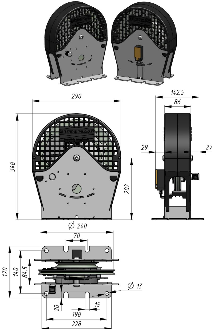
Ограничитель скорости рассчитан на работу с **канатом диаметром 6 мм.**
