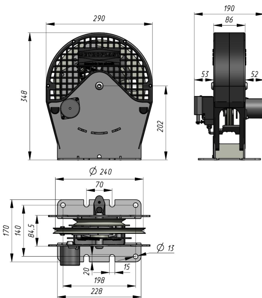
Ограничитель скорости рассчитан на работу с **канатом диаметром 6 мм**.
