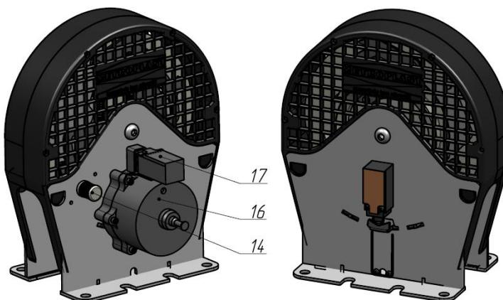
Отличие модели 114 OC Moment 250 A3 от 113 OC Moment 250 MR в том, что дополнительно установлен электромагнит **поз.16**. Во время движения кабины лифта на электромагнит **поз.16** подается напряжение и шток находится во втянутом положении. При любой остановке кабины лифта с электромагнита **поз.16** снимается напряжение и пружина
